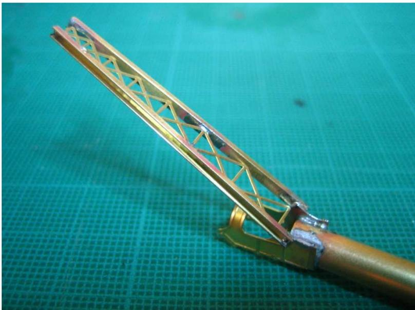
Después separamos las puntas y colocamos la celosía interior dando un punto de soldadura en cada viga.
